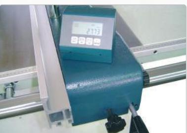
**Medidor digital del corte paralelo**
