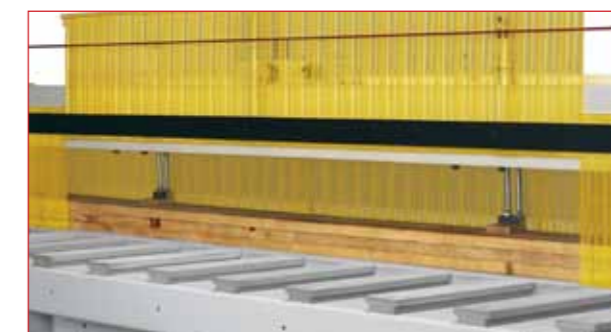
Sistema di guida del carro porta lama Guides du chariot porte-lame Slideways of the blade holder carriage Sistema de guía del carro porta-disco
