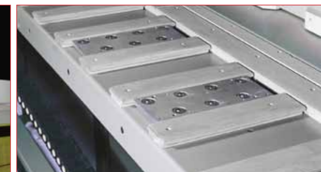
Piastre di scorrimento con sfere a tenuta stagna (opzionale) Plaques de glissement avec billes étanchées aux poussières (option) Dustproof ballplates (optional) Plancha a esferas para el deslizamiento del tablon (opcional)
