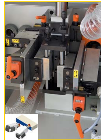
Grupo refilatore HF 12.000 g/1' inclinato a 15°
